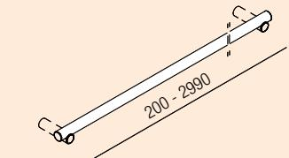
Customized bar, ø 30 mm line, length from 200 mm to 2990 mm / Barra su misura ø mm 30, lunghezza da mm 200 a mm 2990
