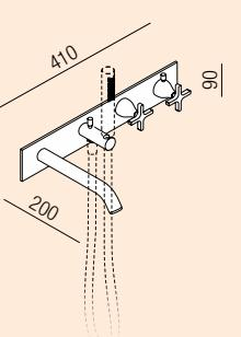
Built-in thermostatic bathtub tap unit with flow deviator and handheld shower holder / Gruppo vasca termostatico ad incasso con deviatore e supporto per doccetta
