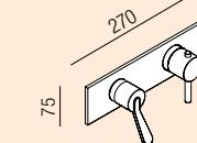
Thermostatic built-in mixer tap with three way diverter / Miscelatore termostatico ad incasso con deviatore a tre vie
