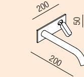
Built-in washbasin set with single lever joystick mixer tap, with horizontal spout (spout 20 cm) / Gruppo lavabo con miscelatore monocomando joystick ad incasso, con bocca orizzontale (bocca cm 20)
