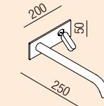
Built-in washbasin set with single lever joystick mixer tap, with horizontal spout (spout 25 cm) / Gruppo lavabo con miscelatore monocomando joystick ad incasso, con bocca orizzontale (bocca cm 25)
