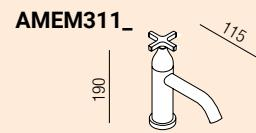
Washbasin single hole mixer tap, with single gradual flow control / Miscelatore lavabo monoforo, monocomando a funzionamento progressivo
