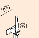
Built-in single lever joystick mixer tap with hand-held shower / Miscelatore monocomando joystick ad incasso completo di doccetta
