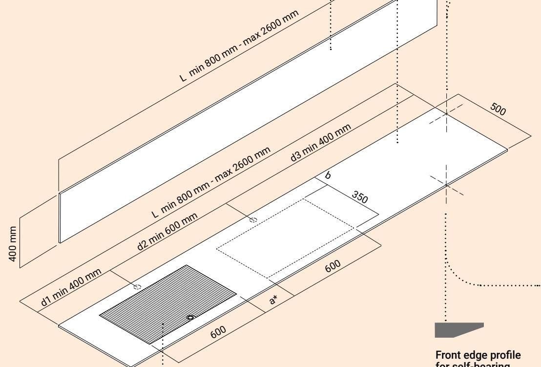
Lateral edge profile for self-bearing countertop / Profilo del bordo laterale per piani autoportanti
