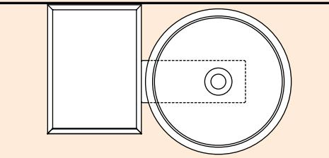
The Lariana storage unit is fixed to the left or right support when this one is parallel to the wall. The Flat XL and Lato containers can also be combined with this support / Il contenitore Lariana viene fissato al supporto a destra o a sinistra del lavabo quando questo è posto parallelo alla parete. Possono essere affiancati al supporto anche i contenitori dei programmi Flat XL e Lato
