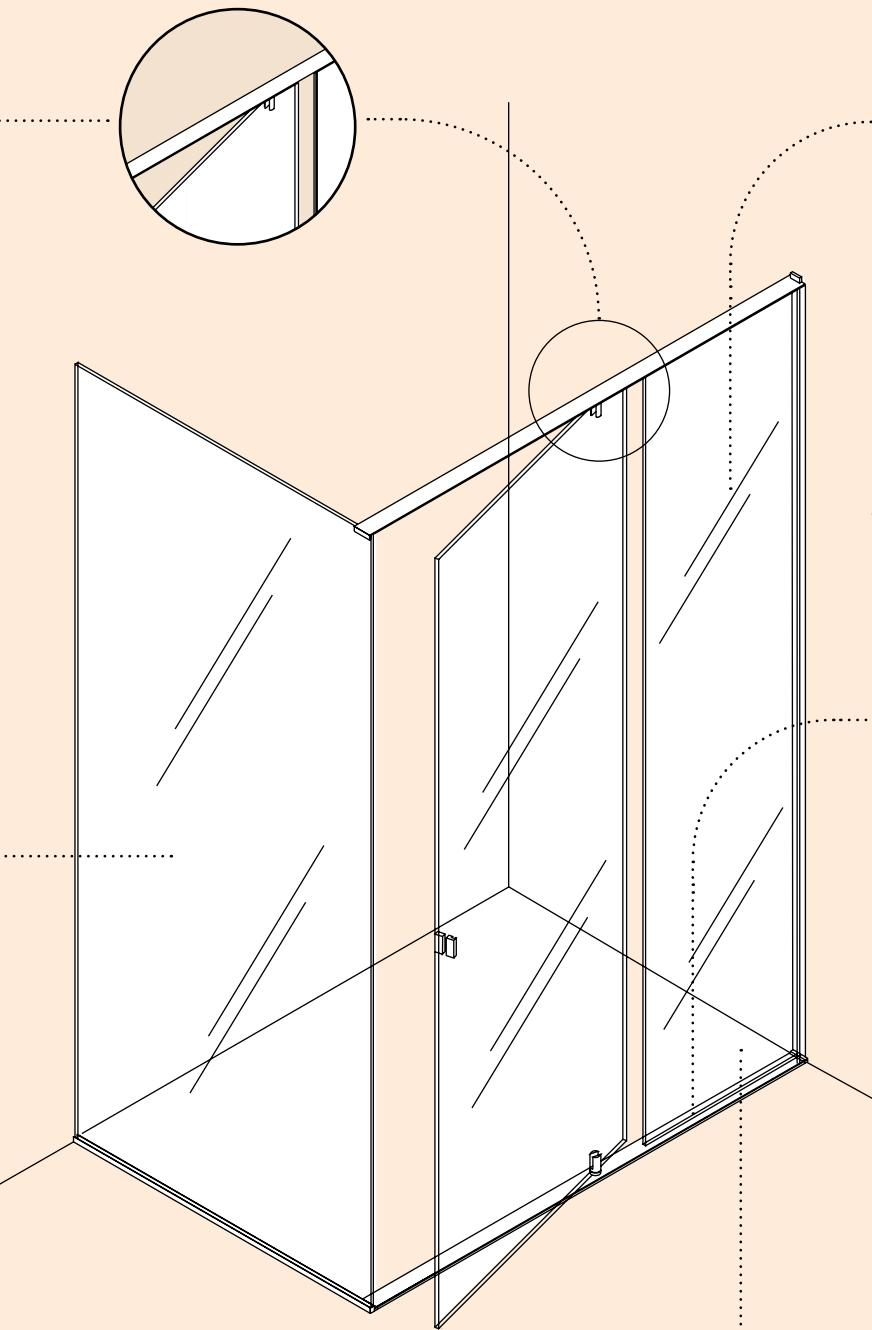
**It is possible to decide the opening side of the door: right (with hinges on the right) or left (with hinges on the left)** / È possibile decidere il lato di apertura della porta: destro (con cerniere a destra) o sinistro (con cerniere a sinistra)
