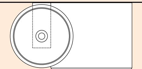
The support can also be positioned perpendicular to the wall, this allows you to use also the Flat XL and Lato containers / Il supporto può essere posizionato anche perpendicolarmente alla parete, questo permette l'accostamento dei contenitori dei programmi Flat XL e Lato.
