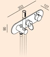
**Built-in thermostatic tap unit with flow deviator and hand-held shower holder /** Comando termostatico ad incasso con deviatore e supporto per doccetta
