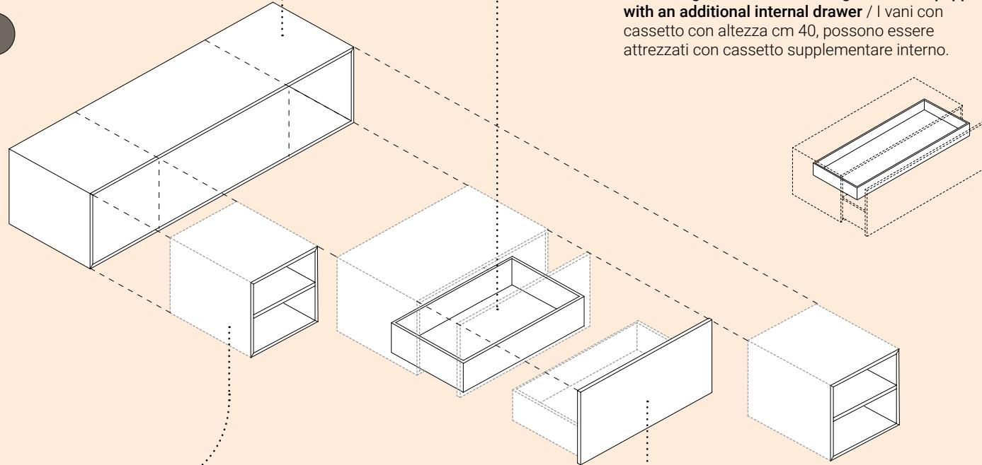
The open compartments have standard lengths of 40 or 60 cm, and are available in the same finish as the casing. Other than the standard measurements, special dimensions are possible / I vani a giorno hanno dimensioni standard cm 40 o 60, sono disponibili nella stessa finitura della cassa. Oltre alle misure standard sono possibili dimensioni speciali
