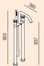
Floor mounted bathtub tap with dual control, flow deviator and water connection for hand-held shower / Gruppo per vasca a doppio comando a pavimento, con deviatore e presa d'acqua per doccetta
