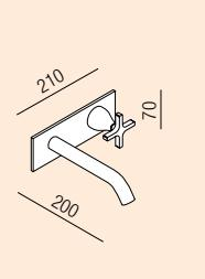
Built-in washbasin mixer tap with single gradual flow control / Gruppo lavabo ad incasso monocomando a funzionamento progressivo
