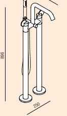
**Floor mounted bathtub tap with dual control, flow deviator and water connection for hand-held shower /** Gruppo vasca a doppio comando con deviatore e presa d'acqua per doccetta, fissaggio a pavimento
