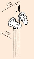
**Built-in single lever tap unit with flow deviator and hand-held shower holder /** Comando termostatico ad incasso con deviatore e supporto per doccetta
