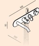
**Thermostatic bathtub taps set with diverter and hand held shower support /** Gruppo termostatico ad incasso per vasca, con deviatore e supporto per doccetta
